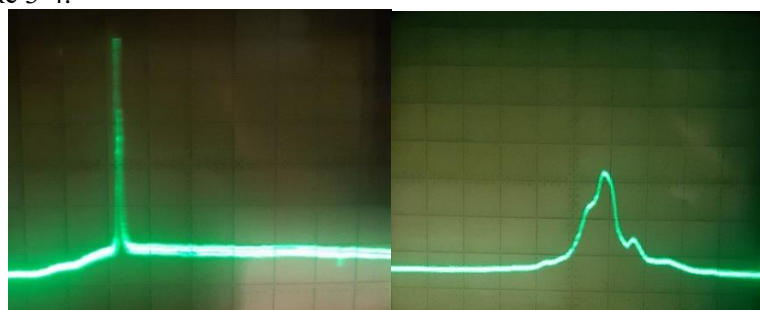
Рис.3 – Движение осциллограммы при микросмещении детали
