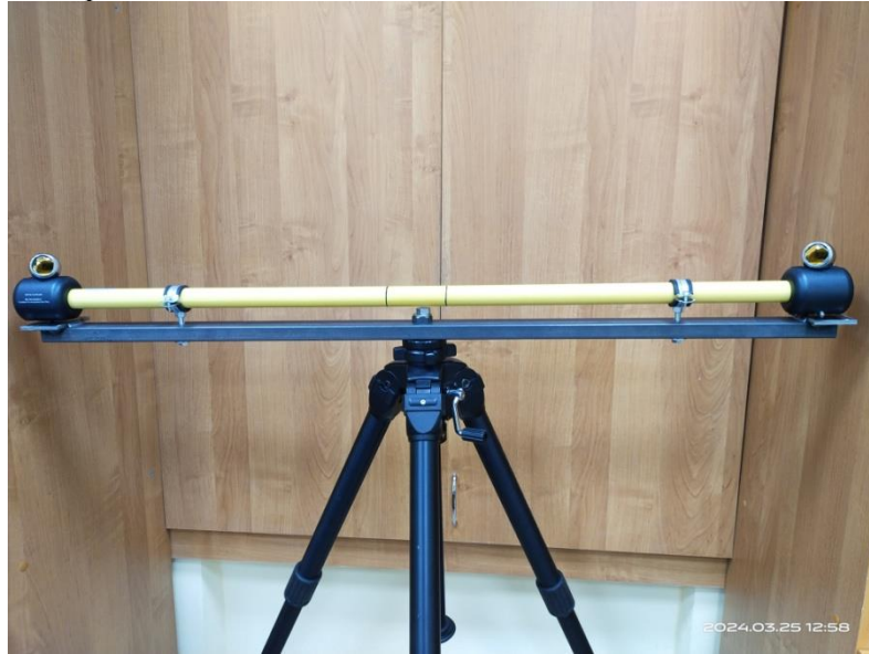
Рис. 1. Приспособление с закрепленной мерой длины API RADIAN
