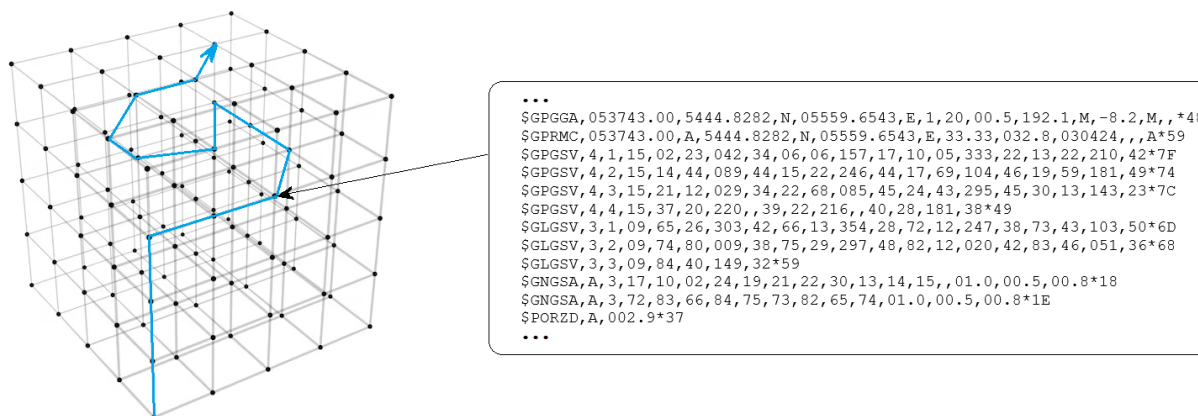
Рис. 3. Работа виртуального полигона на примере траектории движения БАС. Сформированная строка навигационных данных в формате NMEA сообщения
