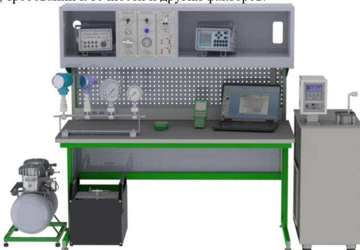
Рис. 2 – Пример стенда для поверки и калибровки средств измерений температуры.
