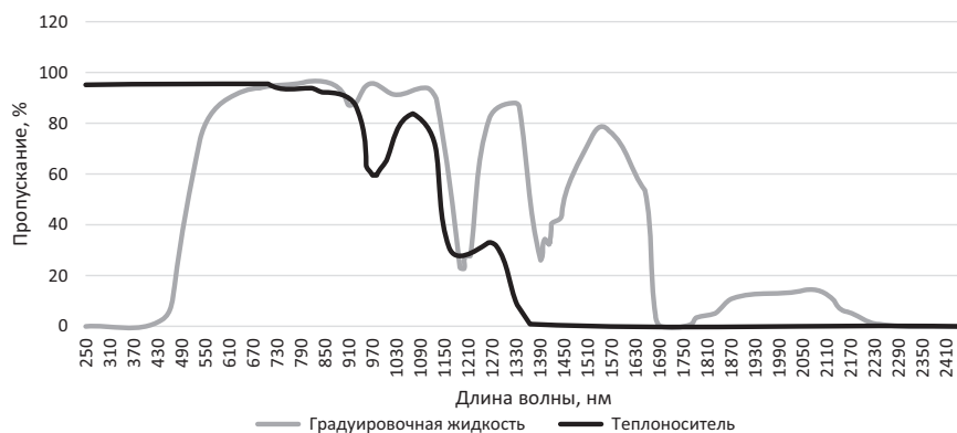
Рис. 2. Сравнение спектра пропускания градуировочной жидкости (жидкости-компаратора) и материала теплоносителя
