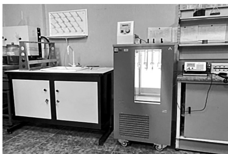
Рис. 1. Система первичного измерения вязкости (метод 1)
