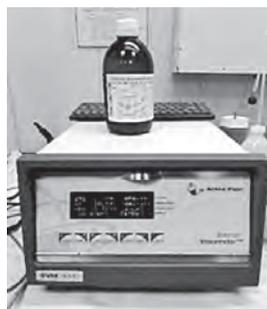
Рис. 2. Вискозиметр Штабингера 3000 (метод 2)
