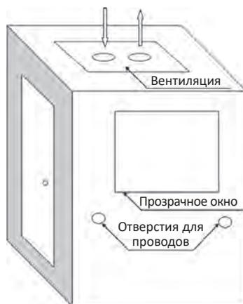
Рис. 1. Шумоизоляционная камера для поверки акустических средств измерений
