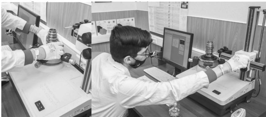
*Рисунок 1. Работа на кругломере RoundTest RA-120P*
