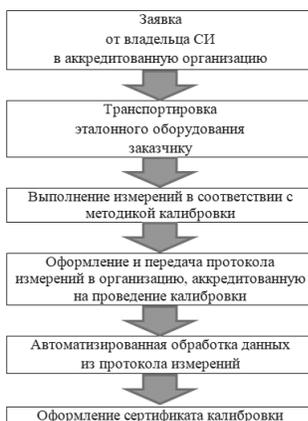
Рисунок 1. Блок-схема концепции автоматизированной дистанционной калибровки координатных средств измерений
