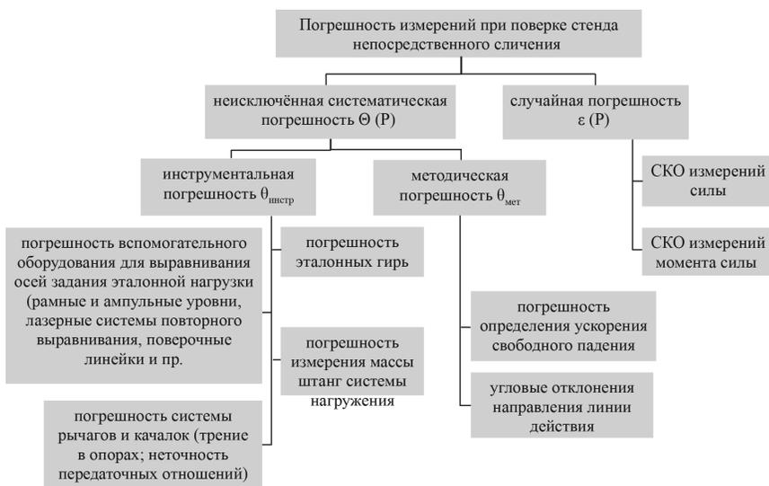
Рисунок 1. Основные источники погрешностей измерений при поверке стендов непосредственного сличения
