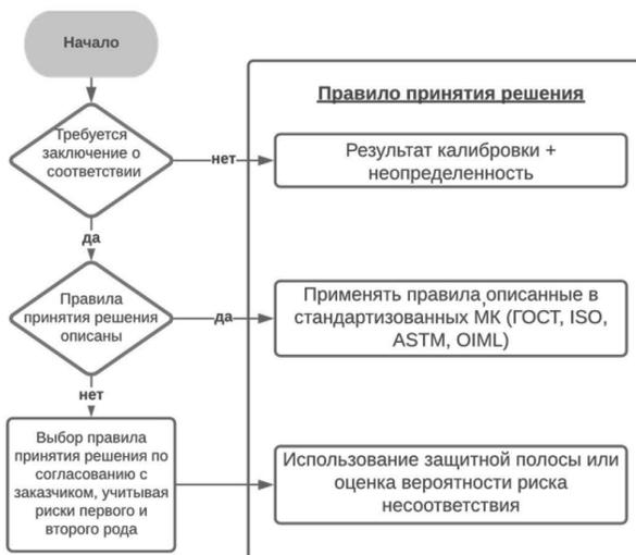
Рисунок 1. Блок-схема принятия решений
